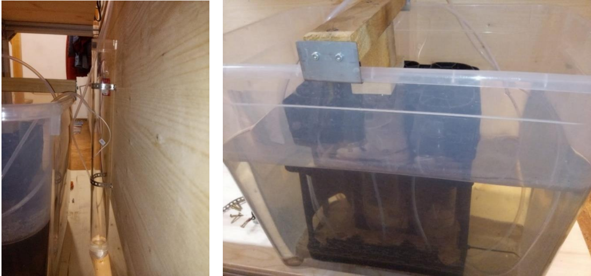
Abbildung 15: Gasbefeuchter (links) aus einem Acrylglaszylinder und der hydrostatische Gasspeicher bestehend aus 6 PET-Flaschen je 1 l
