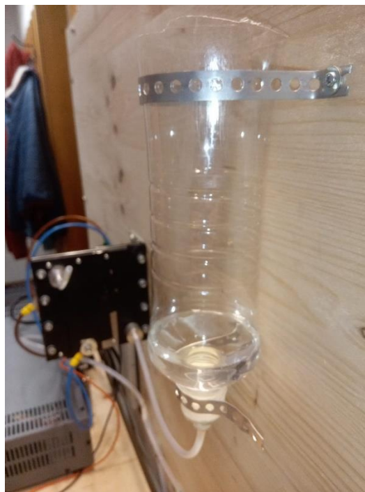
Abbildung 16: Wasserspeicher und -zufuhr auf der Kathodenseite
