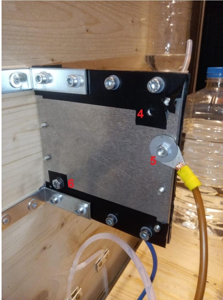
Abbildung 8: Aufbau der Brennstoffzelle (Anodenseite)
