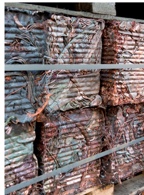
Oben: Sortenrein getrennte Metalle werden in Quader gepresst und können so platzsparend gestapelt werden.
